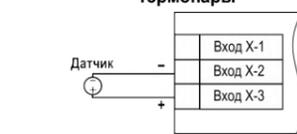
Рисунок 6 – Схема подключения термопары
