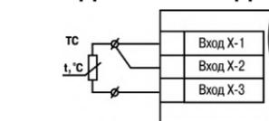
Рисунок 4 – Трехпроводная схема подключения ТС
